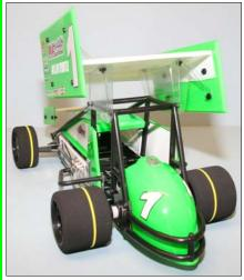
LENGTH 15.5" (395MM) WIDTH 8" (203MM) WHEELBASE 10"(254MM) HEIGHT 9.8" (249MM)
